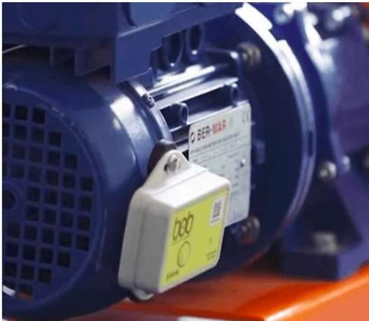
Bob Assistant, de NKE Watteco, est un système de maintenance prédictive. Il analyse en permanence les données fournies par plusieurs capteurs pour anticiper les défaillances à l'aide de modèles de machine learning.
